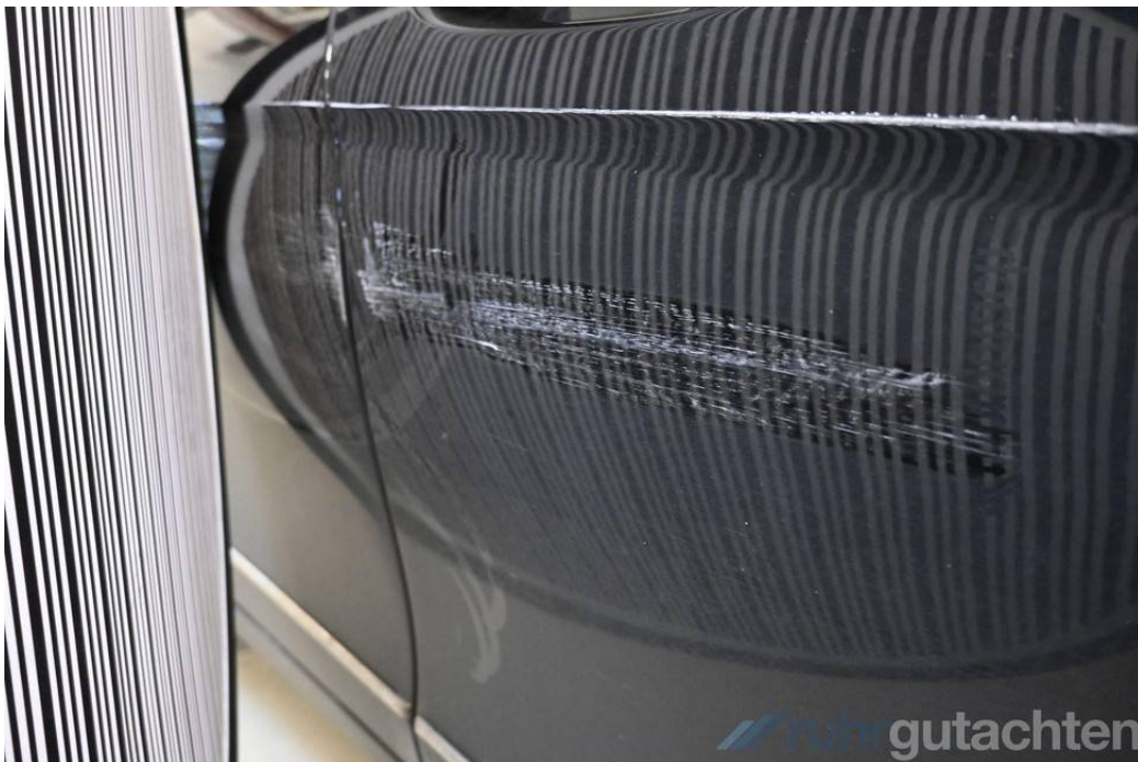
Tür vorne rechts kratzbeschädigt
