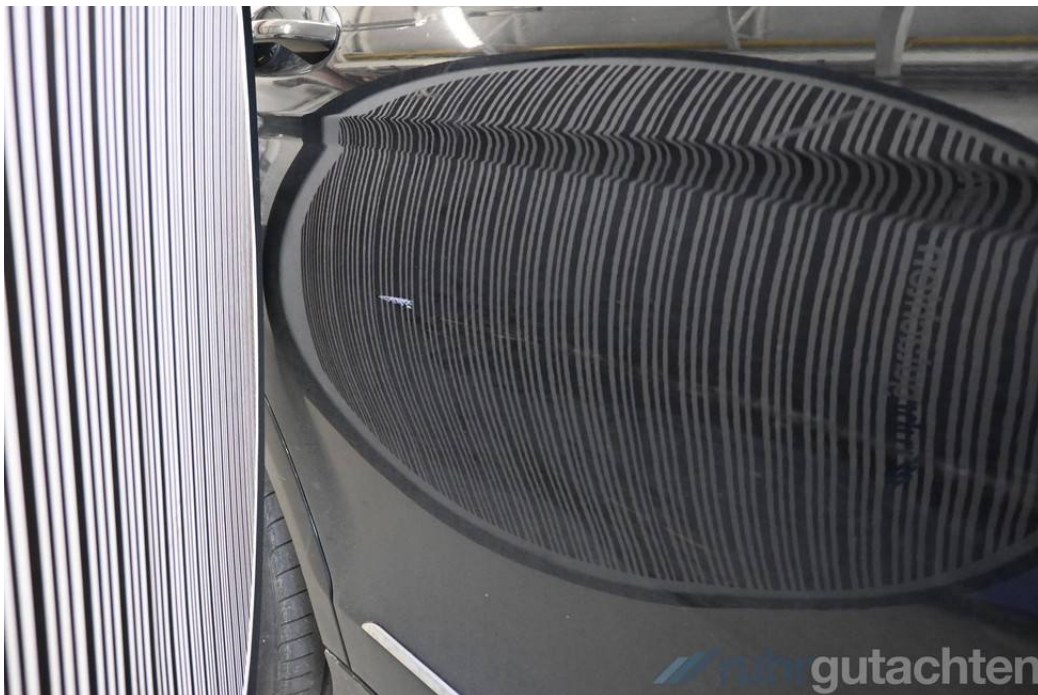
Tür hinten rechts kratzbeschädigt und verformt
