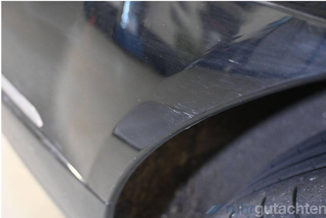
Heckverkleidung rechts kratzbeschädigt
