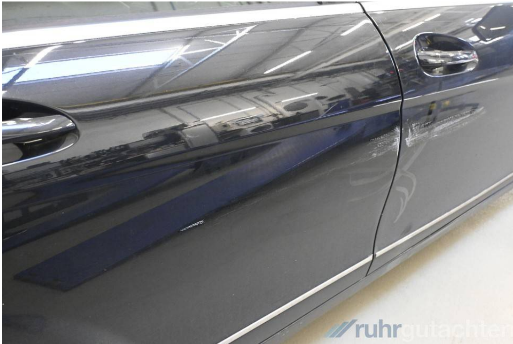
Tür hinten rechts kratzbeschädigt und verformt
