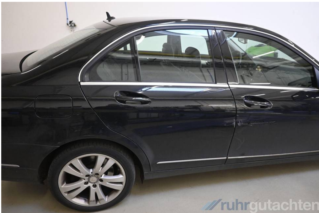
Tür hinten rechts kratzbeschädigt und verformt
