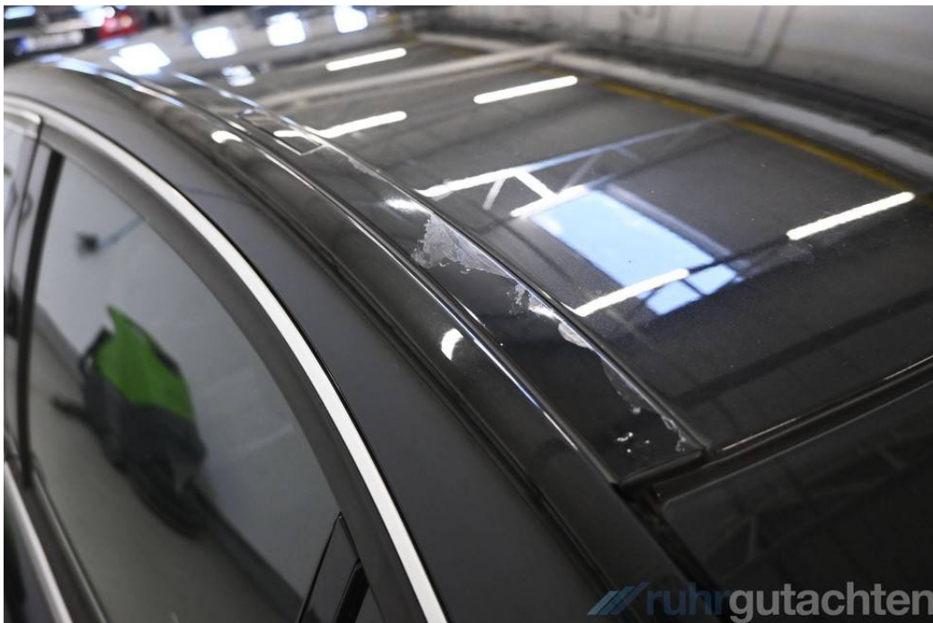
Nicht reparierter Vorschaden: Dachleiste links korrodiert
