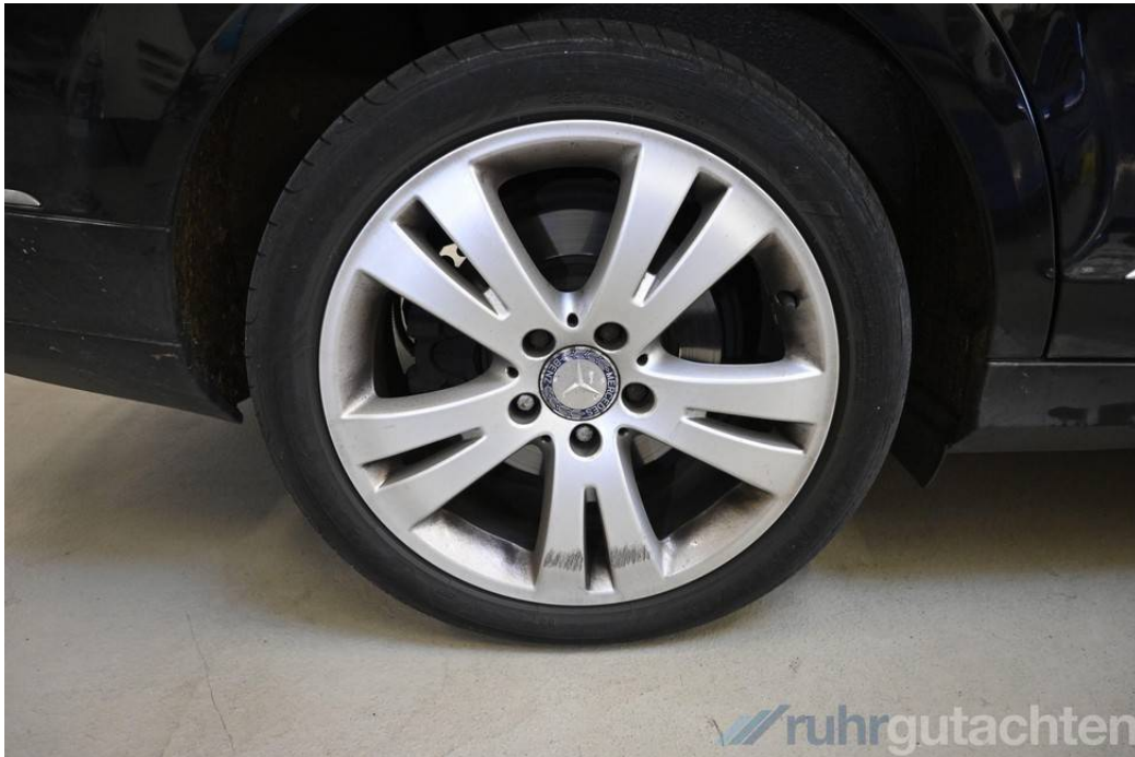
Nicht reparierter Vorschaden: Leichtmetallrad hinten rechts kratzbeschädigt
