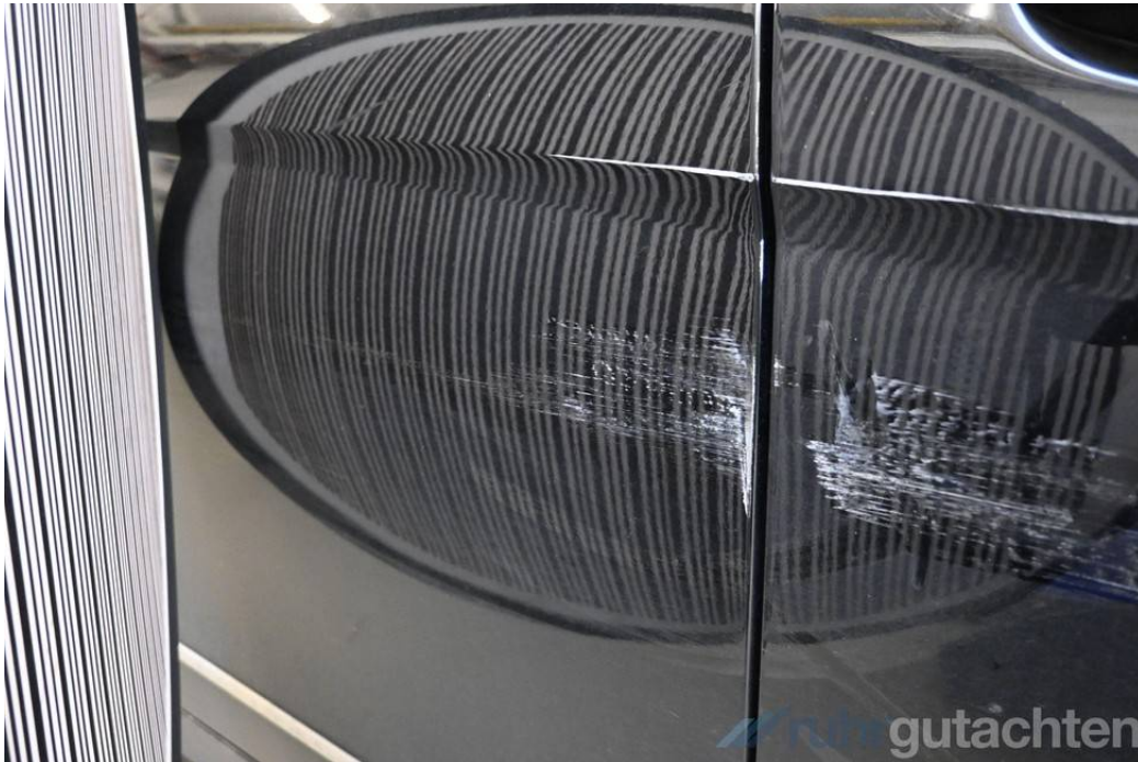
Tür hinten rechts kratzbeschädigt und verformt
