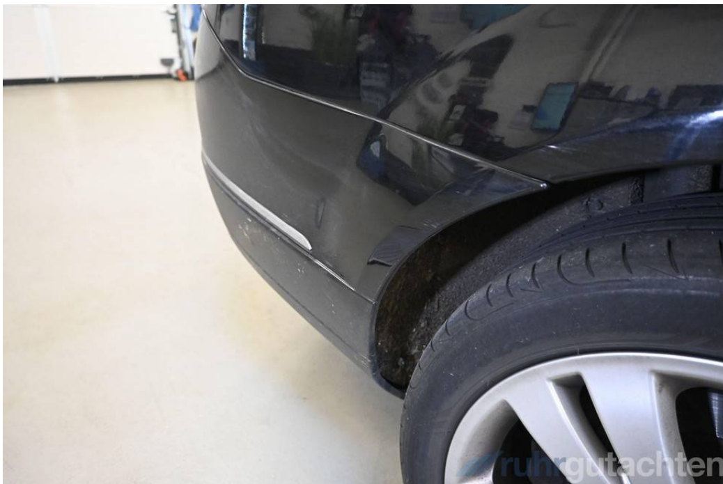
Heckverkleidung rechts kratzbeschädigt
