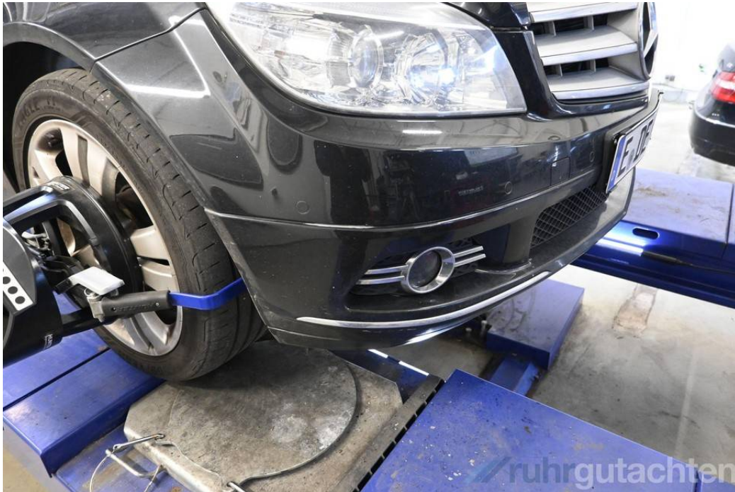
Nicht reparierter Vorschaden: Stoßfänger vorne Lackabplatzung
