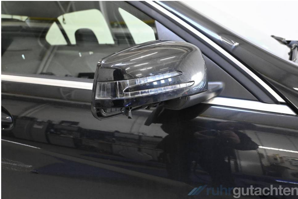
Außenspiegel rechts gebrochen
